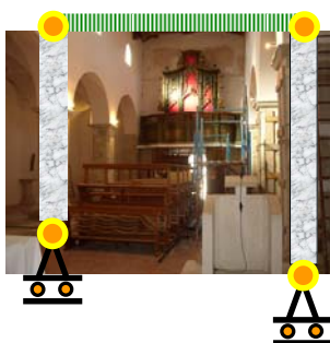
Figura 11. Schema strutturale per le azioni sismiche trasversali. La colonna e il sovrastante paramento murario sono idealizzabili come un ritto. Il coperto, ossia la capriata lignea, è idealizzabile come un traverso.
